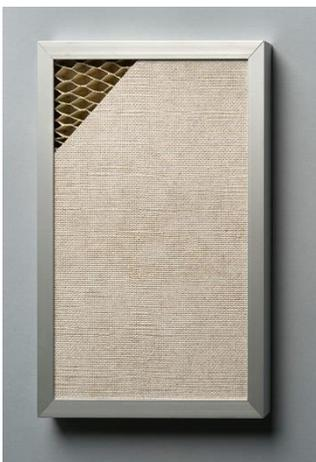
**Abb. 1: Muster einer nichtbrennbaren Leichtbauverbundplatte aus düBraFa-Decklagen und Papierwaben-Mittellage (Foto HFM)**
