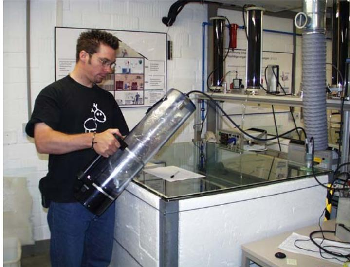
**Bild 1:** Probenahme mit Probenahmegerät aus einer 1 m<sup>3</sup> großen Glasprüfkammer
