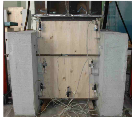
(a) Wöhler-Linie (Kerve als Verbindungsmittel, R = 0,1 ) (b) Push-Out Verurschkörper
