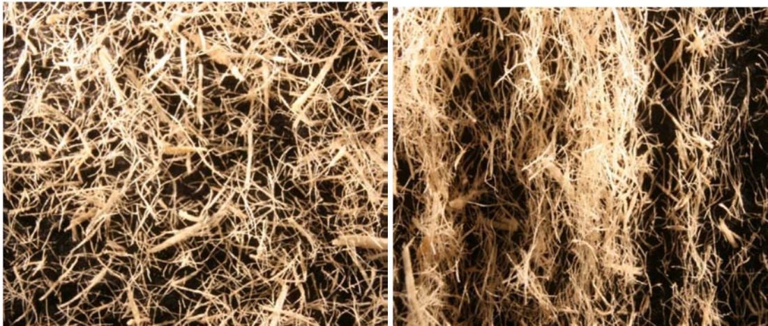
Abb. 1: Faservliese ohne gezielte Vorzugsrichtung (links) und mit Vorzugsrichtung (rechts), Faserorientierung: V-Nut/Langlochblech.
