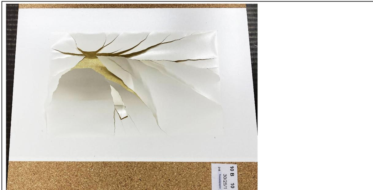
Abbildung 7: Aufgeplatzter J-Film. Das unter dem Film liegende Rechteck aus Trennpapier hat das Verbinden des Films mit der Trägerplatte verhindert.
