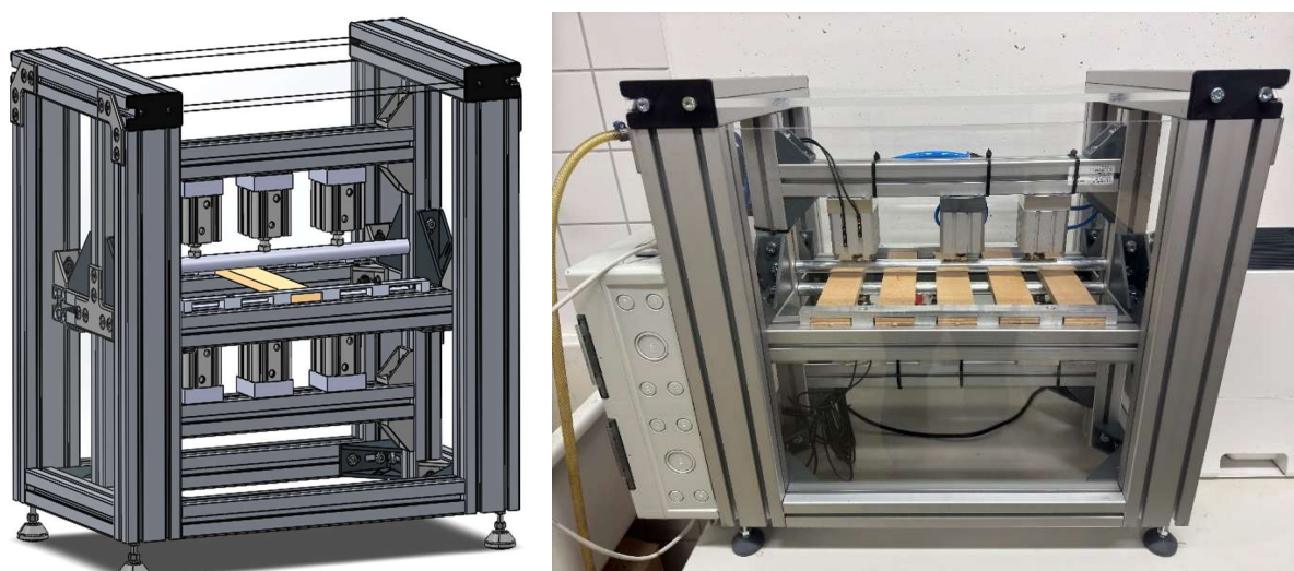
Abbildung 6: Konstruktion und Umsetzung der dynamischen Belastungseinheit.
