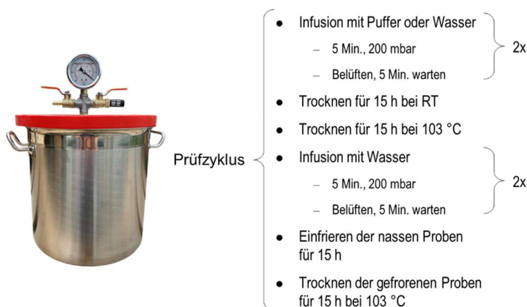
Abbildung 1: Entwickelte Alterungsmethodik auf Basis einer Pufferlösung und harschen Temperaturwechseln. Um sicherzustellen, dass etwaige Performanceverluste der Pufferlösung zuzuschreiben sind, wurde zu Vergleichszwecken ein paralleler Alterungszyklus nur mit Wasser durchgeführt.
