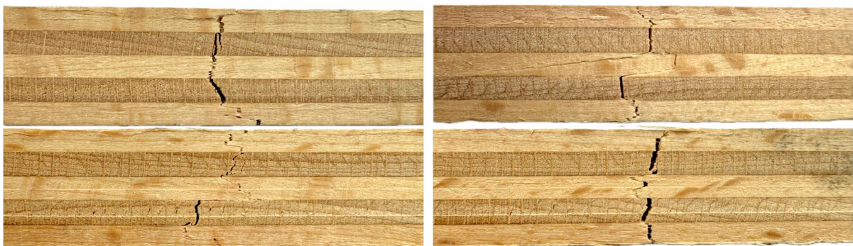
Abbildung 8: Profilaufnahmen der Sperrholzplatten nach 400.000-maliger wechselseitiger Biegebelastung und gleichzeitigem Überlagern von Quell- und Schwindeffekten.
