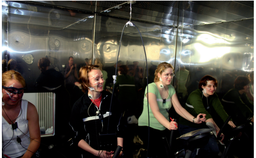
Abb. 8.2: Probanden im VOC-Expositionsversuch mit Kiefernholz in der großen Testkammer des WKI
