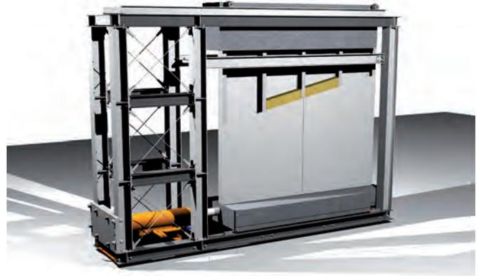
*Geplanter Versuchsstand der Universität Kassel für statische und dynamische Versuche; Entwurf: Uni Kassel*
