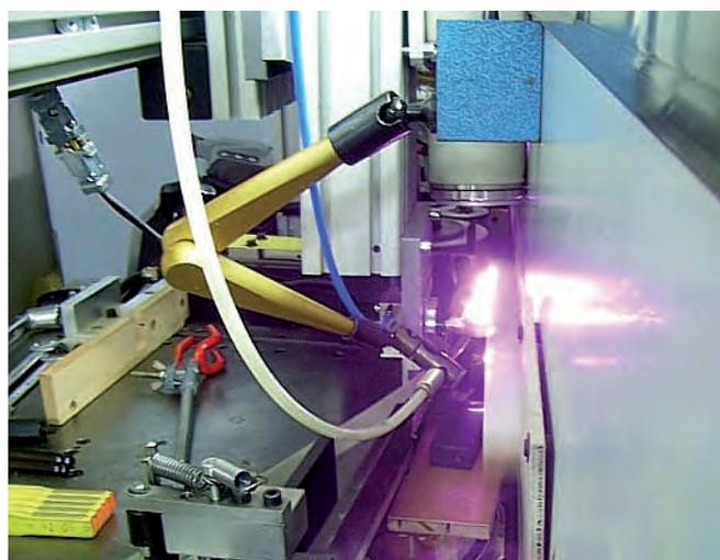
Versuchsstand zum lasergestützten Fügen an einer Kantenanleimmaschine
