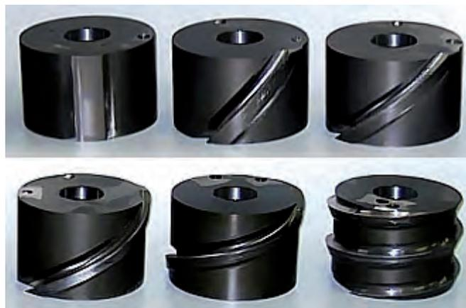
Vergleichswerkzeuge und Versuchsfräser mit Werkzeug-Neigungswinkeln  $\lambda_s$  von 0° bis 85°
