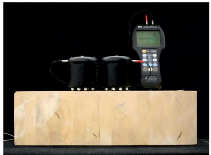
Photo der Ultraschall-Clustersensoren in Echo-Anordnung und der Pulser-/Rezeivereinheit
