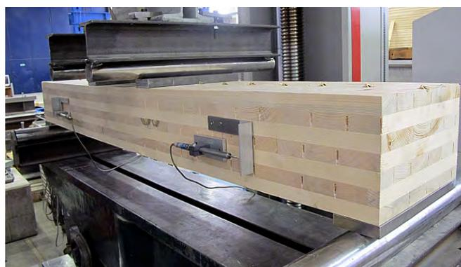
Bild 2: Vierpunkt-Schubversuch am Balkenelement
