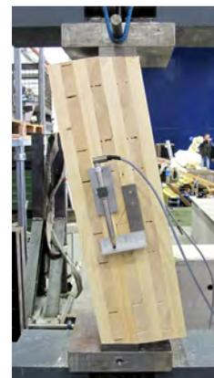
Bild 3: Scherversuch am Schubelement
