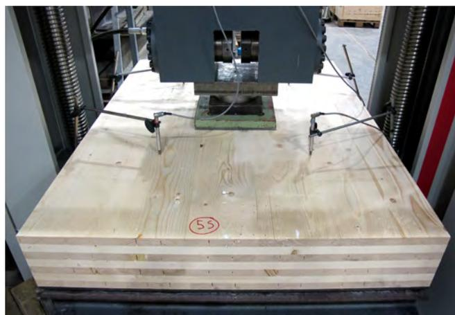
Bild 5: Biaxialer Traglastversuch
