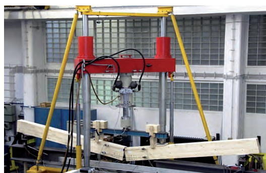
Abb. 3b, unten: Vier-Punkt Biegeversuch
