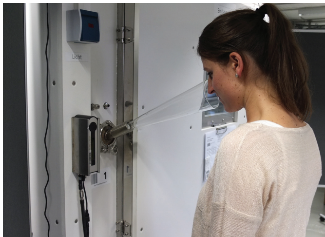
Abbildung 2: Direkte Geruchsbewertung an einer 3 m³ Prüfkammer © Fraunhofer WKI
