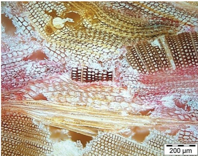
Bild 3: Mikroskopische Aufnahme einer Spanplatte verleimt mit PMDI
